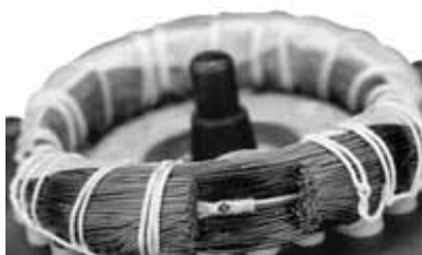
Obr. 48 Snímač PTC zabudovaný ve vinutí
