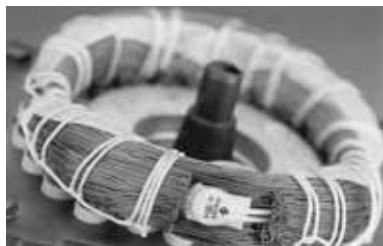
Obr. 50 Teplotní spínač zabudovaný ve vinutí
